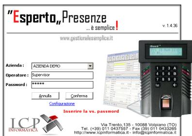
1 Utilizzo di un rilevatore di presenze "Iguard" (fornito su richiesta) funzionante con la tecnica della "tessera di prossimità". Ogni dipendente avrà un badge magnetico che utilizzerà al momento dell'ingresso e in quello dell'uscita. Il software si occuperà di memorizzare gli eventi calcolando in automatico le ore ordinarie, straordinarie e le eventuali assenze (permessi, ferie, mutua, ecc.).
